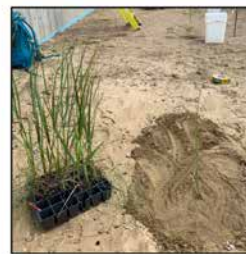
Figure 4. Installation expérimentale avec des plantes Sporobolus spp. dans le canal à grandes vagues du LHE-INRS. Les plantes vivantes ont été transplantées directement dans l'installation d'essai des vagues et ont été arrosées et surveillées pendant trois semaines pour permettre leur implantation dans le sol avant les expériences.
