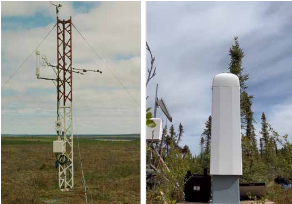
Figure 1. Instruments de mesure pour l'analyse des changes de matière et d'énergie entre sol et ciel. À gauche : tour de covariance des turbulences ; à droite : cénomètre. Source : Bruno Lecavalier.
