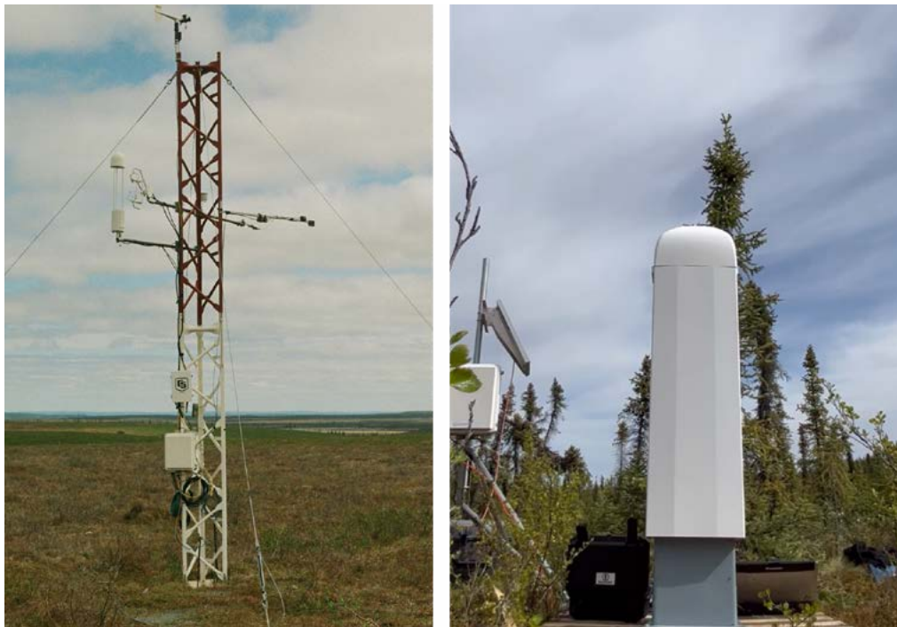
Figure 1. Instruments de mesure pour l'analyse des changements de matière et d'énergie entre sol et ciel. À gauche : tour de covariance des turbulences ; à droite : céloètre. Source : Bruno Lecavalier.
