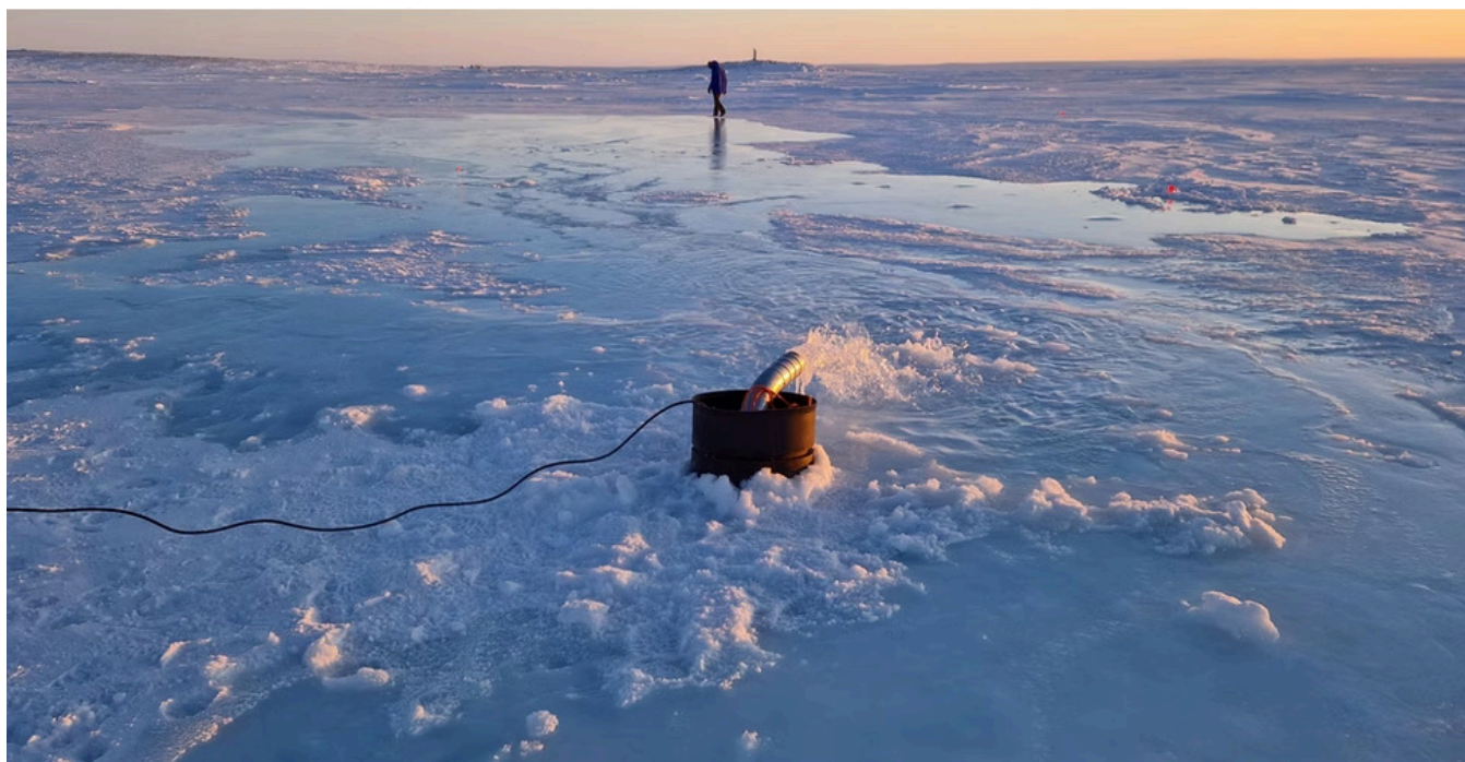
Figure 3. Inondation artificielle au-dessus de la banquise près de Cambridge Bay (Nunavut), afin d'augmenter son épaisseur et sa réflectivité. Photo tirée du site de Real Ice https://www.realice.eco/
